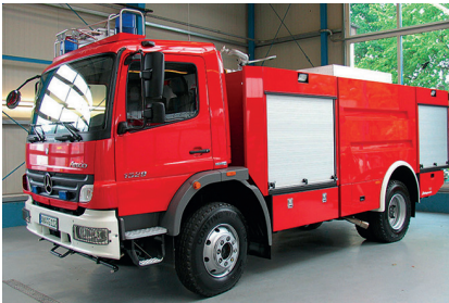
Modulaufbau mit mittigem Löschwassermodul und Gerätemodulen
